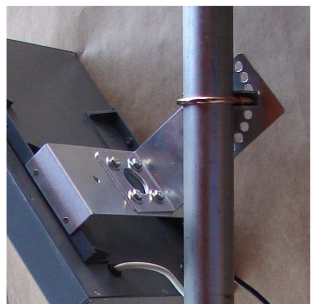
Fixação em poste vertical com leitor a 45° (recomendado para leitor acima de 2 m de altura) usando suporte em "U" e em "L"
