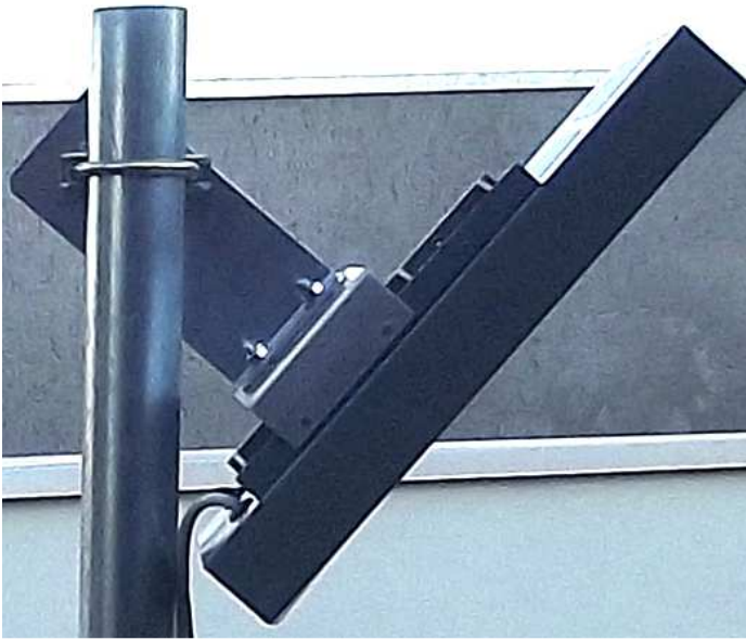
Fixação em poste vertical com leitor a 45° (recomendado para leitor acima de 2 m de altura) usando suporte em “U” e em “L”
