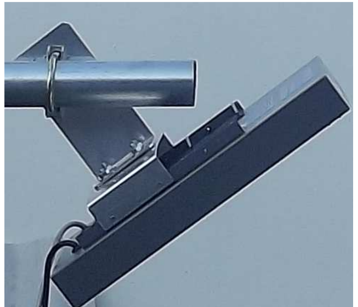
Fixação em poste horizontal com leitor a 45° (recomendado para leitor acima de 2 m de altura) usando suporte em “U” e em “L”
