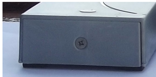
Retire a tampinha para acessar a DipSwitch
