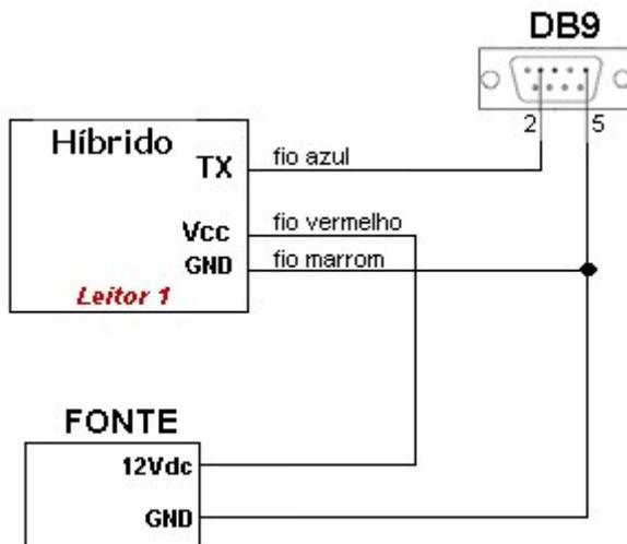
**Serial ASCII (RS-232):** Baud 9600, Sem paridade, 8 bits de dados, 1 bit de parada
