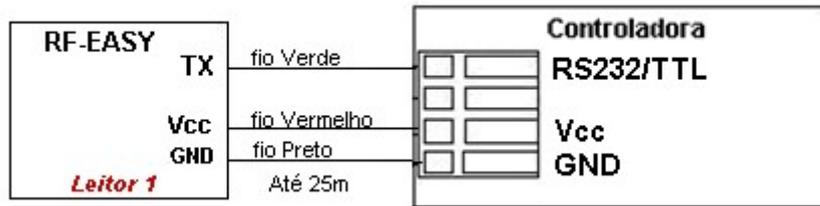
**Serial ASCII (RS-232):** Baud 9600, Sem paridade, 8 bits de dados, 1 bit de parada
