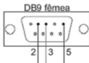
**Serial ASCII (RS-232):** Baud 9600, Sem paridade, 8 bits de dados, 1 bit de parada
